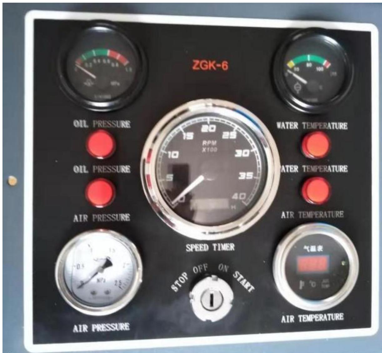
**ZGK - 6 дизельный винтовой контроллер, температура воды, температура воздуха, давление масла, давление воздуха, обороты, счетчик мото часов**
